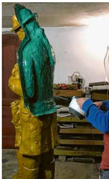
Die Silikonform wird auf die Tonfigur aufgetragen.
