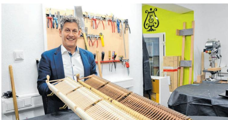
Ein Blick in die Werkstatt beweist: Klavierbau kann auch auf höchstem Niveau ein Beispiel für Nachhaltigkeit sein: Die rund 6.700 Einzelteile der Mechanik eines modernen Steinway-Flügels (hell, links) ersetzen passgenau das Innenleben des Models von 1916 (dunkel, rechts). Marcus Hübner: »So entsteht ein praktisch neu-
