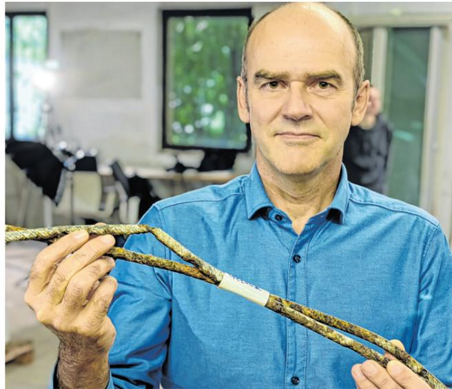
**Kleinste Roststellen, leicht verbogene Drähte beim Einbau – all das hat für Anrisse gesorgt, die unter Spannung gerostet sind. Foto: Branczeisz**
